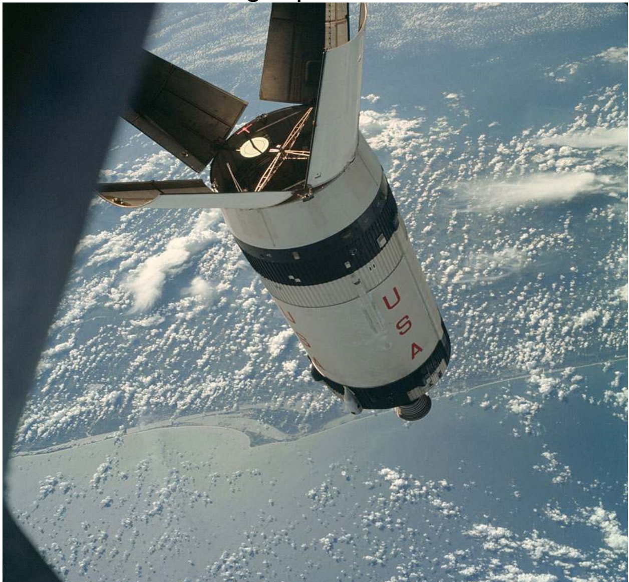
Ausgebrannte 2.Stufe der Saturn IB dient als Kopplungsobjekt
