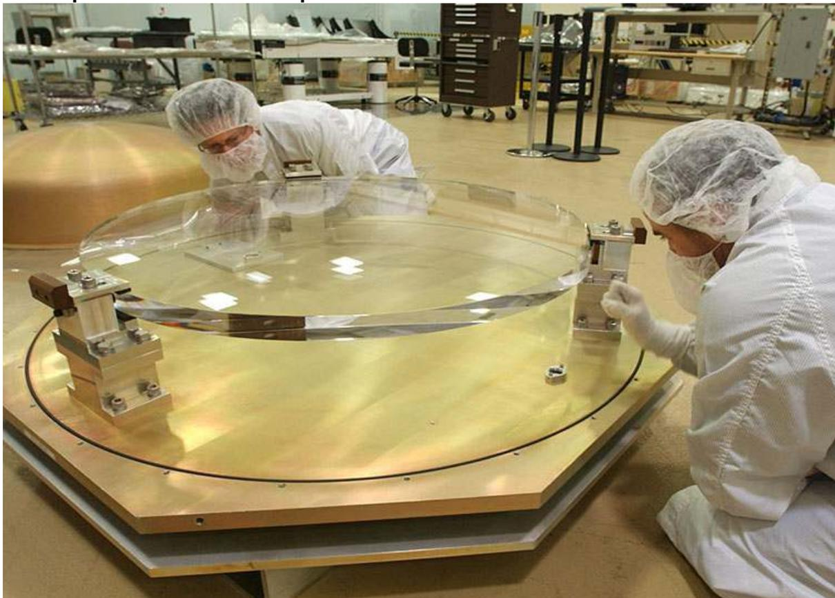
Die Hauptspiegelbasis besteht aus rund 100 hexagonalen Segmenten, die zu einem Stück mit 1,4 m Durchmesser zusammengesetzt wurden, darauf ist der eigentliche sphärische Hauptspiegel montiert.
